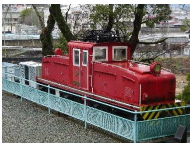
鉱山専用鉄道用電気機関車
