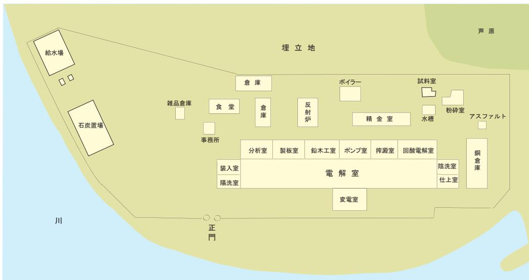
図30 電気分銅所内配置図 別子銅山記念館所蔵資料を元に作成
