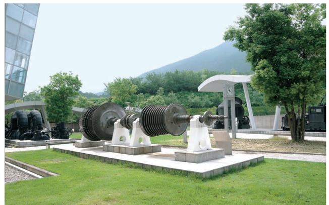
写真20 タービンロータ（中央）とケーシング（左端）
